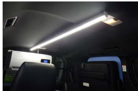
☆車内照明設置状況 ・バッテリーと接続し、車内照度確保。
