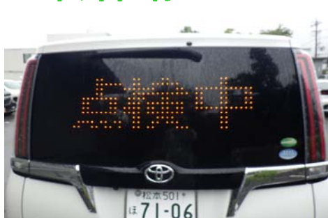
☆電光掲示板 ・交通規制内への配置を想定した、 追突事故防止対策。
