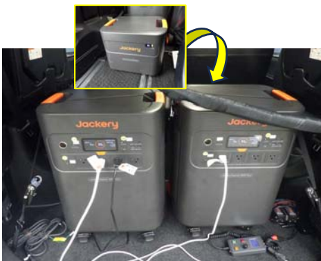
☆バッテリー設置状況 ・大×2台と小×1台を搭載。
