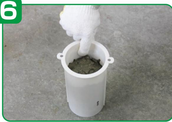
記入面が型枠の内側に接するように、型枠の上縁から1cm~3cmの位置にシールを合わせ指で固定し、コンクリートを流し込みます。
